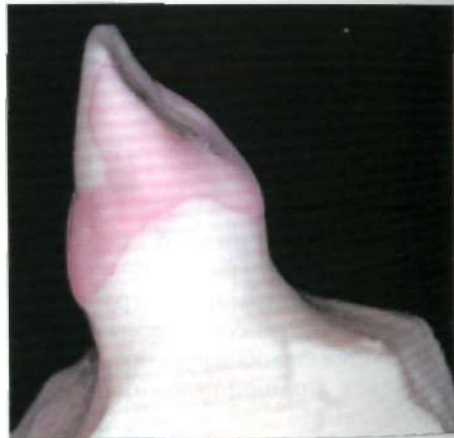
Рис. 12.8. (а—с) Ламинирование в традиционной кера- мике Discgat прямо на огнеупорном штампе для изготовления керамического колпачка толщиной 0,3 мм.
