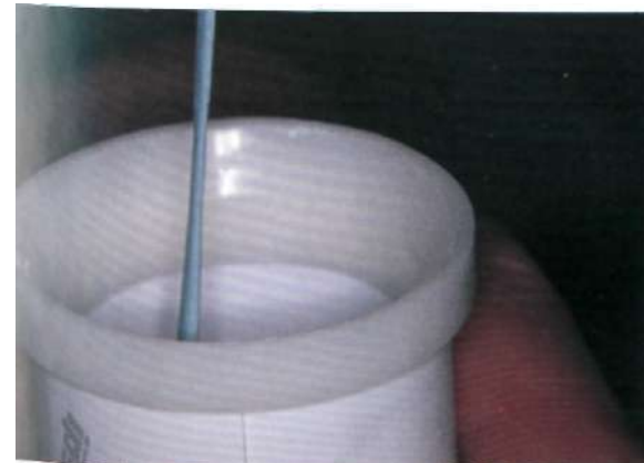
Рис. 3.10. Восковая модель и литник прикреплены к формирователю кольца, которое сейчас наполнено формовочной массой.
