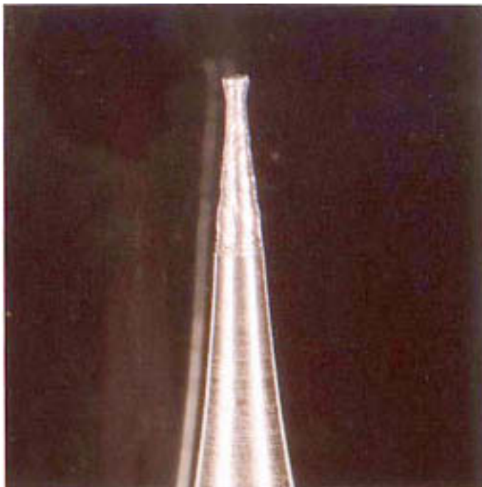
Рис. 2. Обратный конус, самостоятельно изготовленный из конусообразного точильного инструмента. Этот инструмент особенно хорошо использовать для тончайшей обработки бугров и выступов во всех тех случаях, когда конусовидное сверло не подходит.
