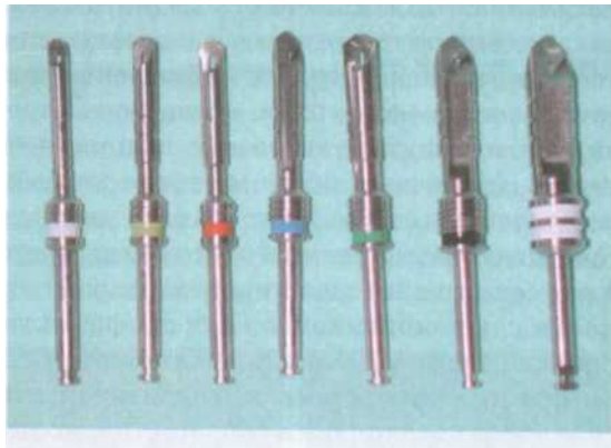
Рис. 20.10. Набор фрез с внутренним охлаждением для формирования ложа внутрикостного имплантата
