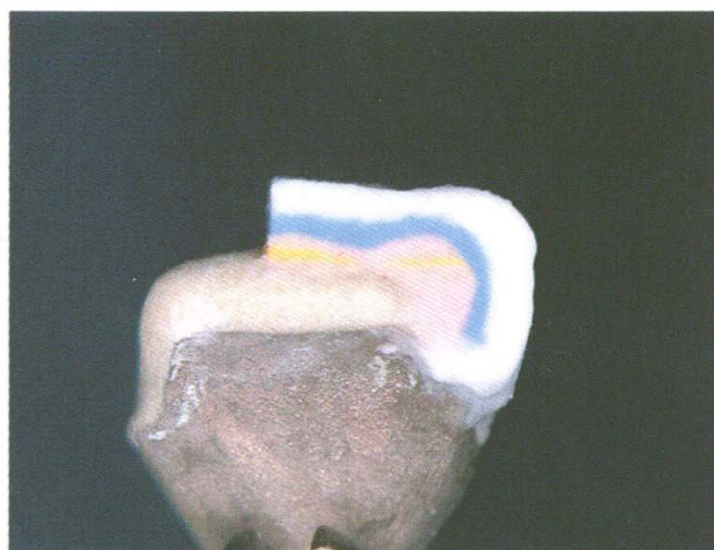
Рис. 50b–e. Поперечные срезы смоделированной коронки. Расположение срезов показано на рис. 18a. В каждом срезе четко обозначены отдельные слои керамики; получены двухслойная конструкция (дентин-эмаль) и эффект полного покрытия коронки эмалью. Слой керамики, имитирующий хроматические пальцеобразные бороздки, расположен точно в середине дентиновой массы.
