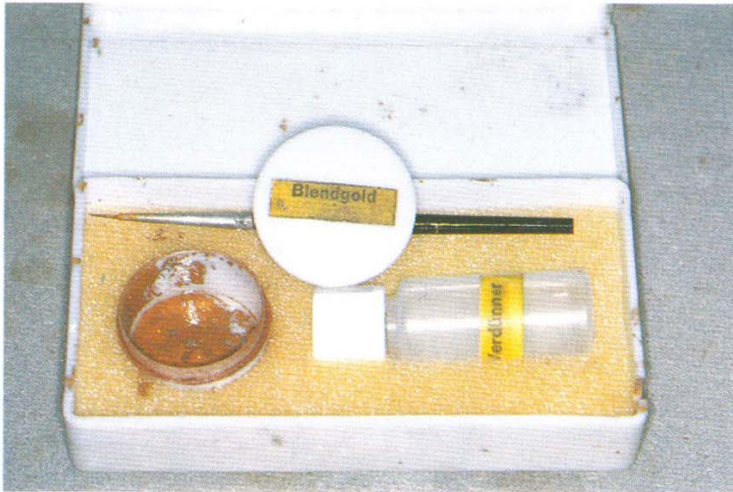
Рис. 6е. При использовании данного метода применяют специальный маскирующий состав New-Blendgold фирмы Heraeus.
