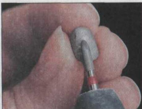
Рис. 19. Обработка металлического каркаса с помощью фрезы
