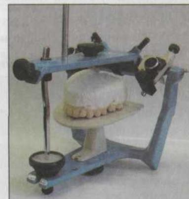
Рис. 34. Позиционирование модели верхней челюсти на постановочном столике артикулятора
